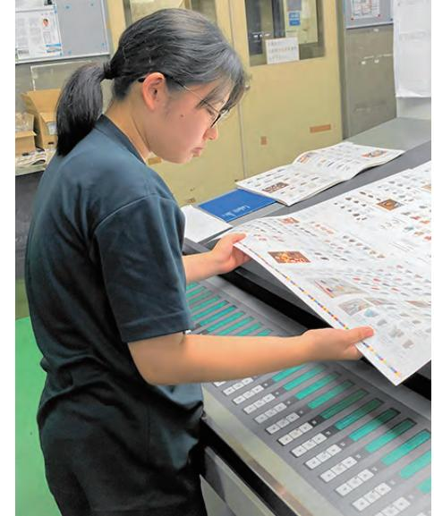
4色刷のオフセット印刷機の機長を任されています。機械を操作し4色の掛け合わせを調整しながら、クライアントが望む色味を正確に再現するのが重要な役割です。
